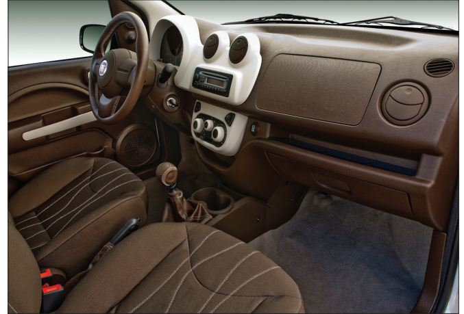
Exterior e interior do Uno Ecology. O protótipo apresentado pela Fiat tem peças reforçadas com fibras de cana-de-açúcar; além de assentos, encostos e carpetes feitos de fibra de coco ou de PET pós-consumo reciclado
