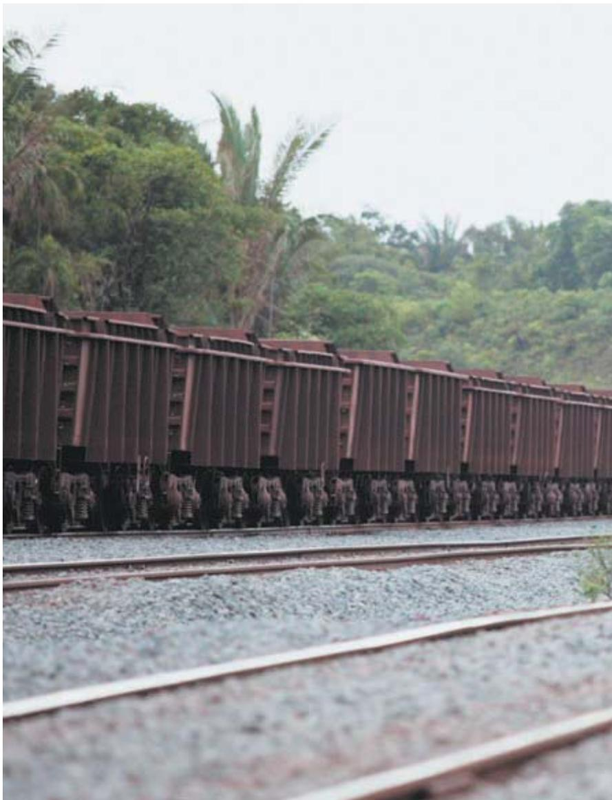
frotas antigas. Foi esse o viés usado em vagões “abelha” da Ferrovia Centro Atlântica (FCA). O modelo dotado de divisões internas para o transporte de bobinas de aço da operadora ganhou um sistema mais resistente a infiltrações e de descarga automática.
